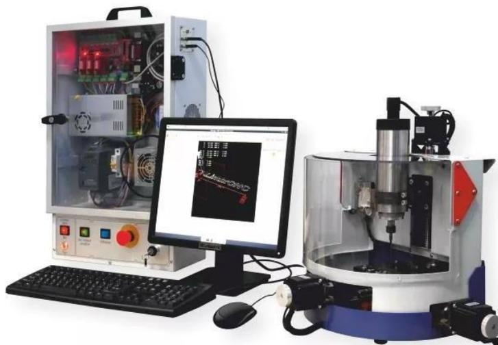
Настольный трех-осевой вертикально-фрезерный станок с ЧПУ, управляемый от персонального компьютера, соответствует по конструкции и функционированию промышленному стандарту. Предназначен для фрезерной и сверлильной обработки деталей, а также для гравировки.
